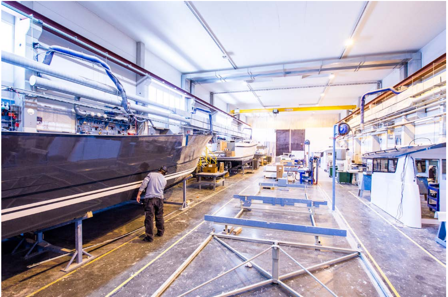
PRODUKSJON FØLGER LEAN-metodikken for å gjøre produksjonen mer optimal og smartere, ble innført for fem år siden. Her er Sargo 36 under bygging.
