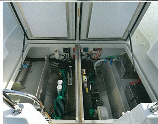
MOTORUTRYMMET HAR PLATS för två spisar, men det finns ingen anledning att ha det. Motorvalet, D6-370, är optimalt för båten. En strålande kombination.
