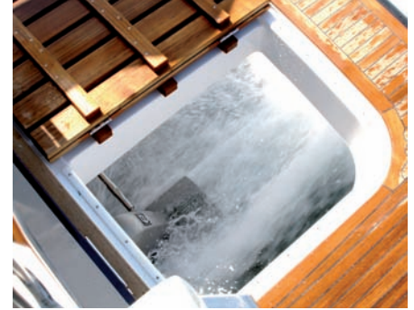
Grätings-Durchbruch auf der Badeplattform mit Zugang zu den Z-Antrieben.
